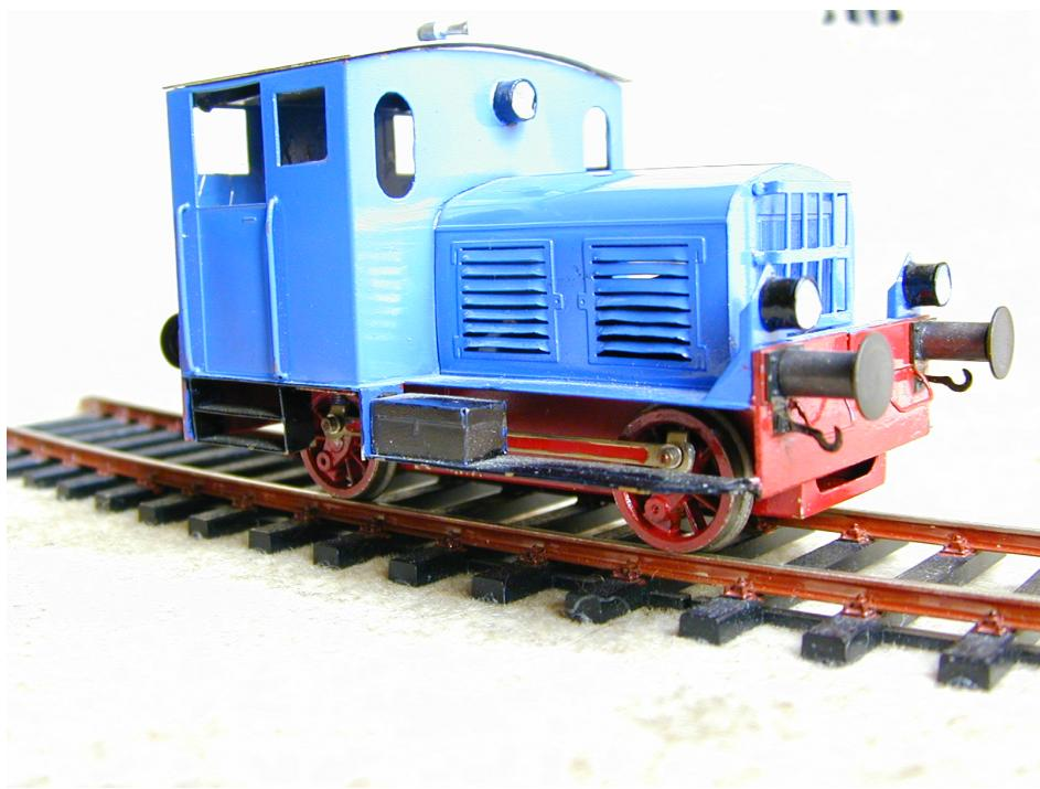
Das Modell war ursprünglich für den Antrieb von Portescap Typ RG 4 vorgesehen. Nach Auslaufen des Motors ist die Ätzplatte mehrmals geändert worden, so dass hier mehrere unterschiedliche Getriebemotoren eingebaut werden können. Aktuell ist bei Slaters der Nachfolger SG4 verfügbar.
