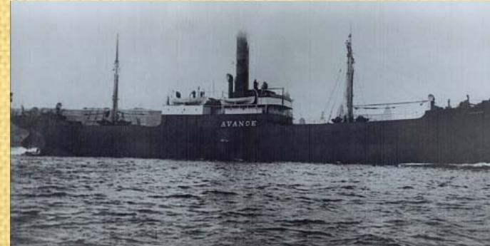
d Avance / erbaut 1870 bei Bergsunds M.V., Stockholm / 284 BRT / 157 NRT / 41,7 × 6,7 m / Verbundmasch. / 160 PSI
